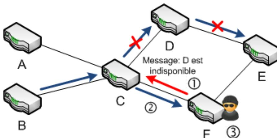
But de l'attaque : **dérouter les paquets** à destination du réseau E, vers le réseau F maîtrisé par l'attaquant.
