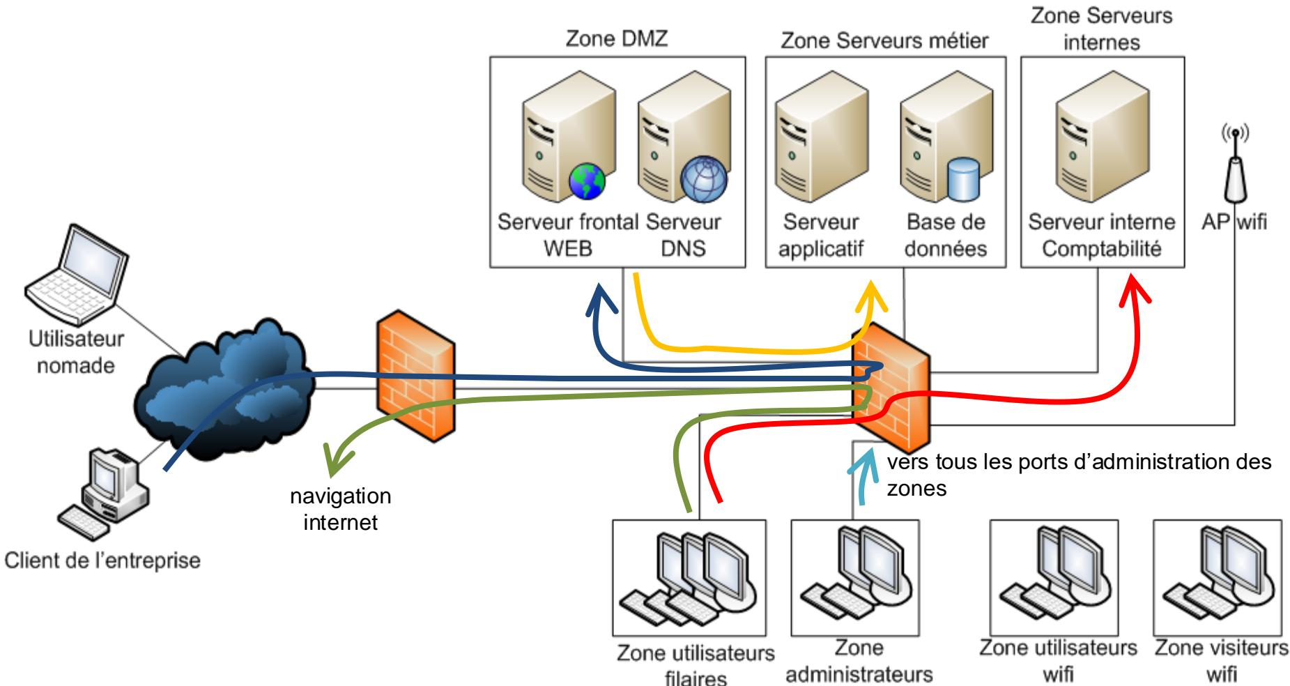
Réseau avec des zones segmentées, et un filtrage systématique via le pare-feu, y compris pour les flux internes.
